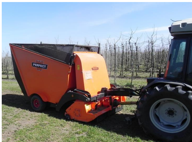
Figura 2: Aspiratore fogliare (ditta PERFECT) utilizzato per spostare le foglie cadute dalle strisce degli alberi in autunno (Foto: B. Benduhn, febbraio 2014)
