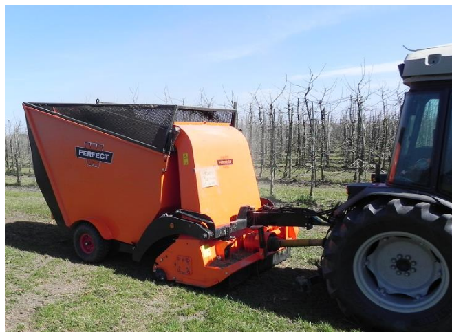
Fot. 2.: Odkurzacz do liści (Firma PERFECT) używany do usuwania opadłych liści z pasów drzew jesienią (Fot.: B. Benduhn, luty 2014)
