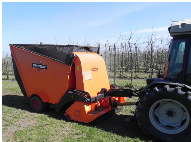
Foto 2: Opraapwagen (Bedrijf PERFECT) voor het verwijderen van afgefallen blad uit de boomstrook in de herfst (Foto: B. Benuhn, februari 2014)
