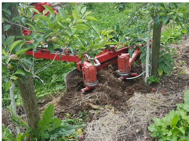
Imagen 1. Desmenzador giroscópico de LADURNER en acción, Foto: N. Oeser 2019.
