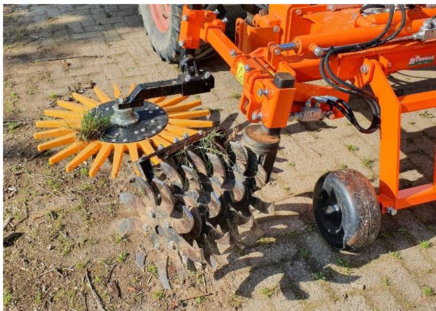
Imagen 1. Azada de rodillo Adelhelmer combinada con azada de dedos K.U.L.T., Foto: N. Oeser, FÖKO, 2019.
