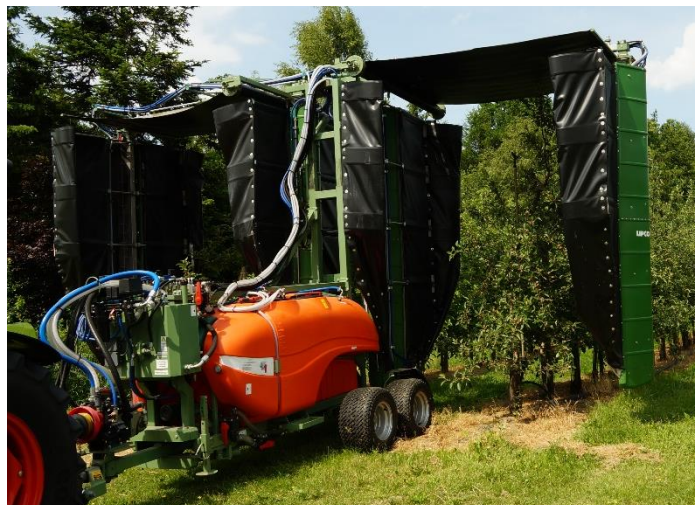
Imagen 1: LIPCO OSG-NVM2 Reciclaje-Túnel pulverizador. Foto: Ralfs, 2017.
