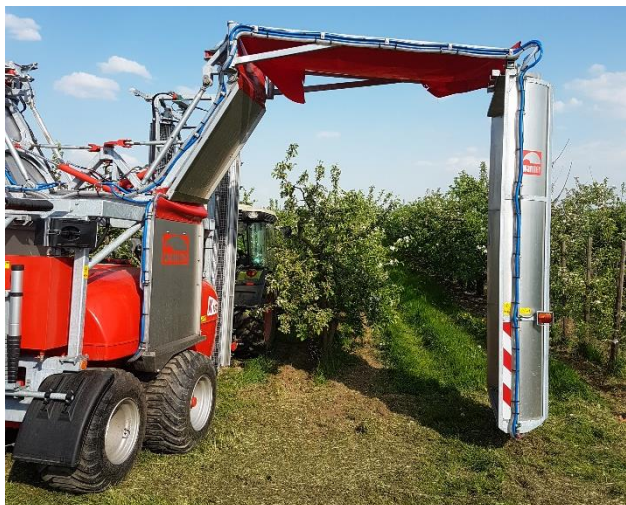
Imagen 2: WANNER NTR20 Pulverizador reflector-reciclador. Foto: N, Oeser, 2018.
