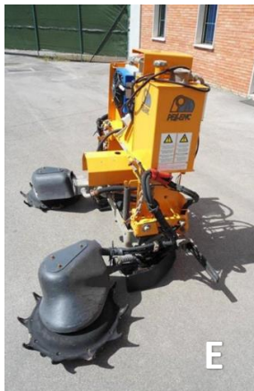
Foto A. Mulchen met schors, Foto B. Mulchen met maïsetmeelfolie, Foto C. Onkruidbrander, Foto D. Tweezijdige schijveneg, Foto E. Roterende schijveneg, Foto F en G: Borstelmachine, Foto H. Schijvenploeg of rollhacke. Foto's Ewald Lardschneider, Onderzoekscentrum Laimburg.
