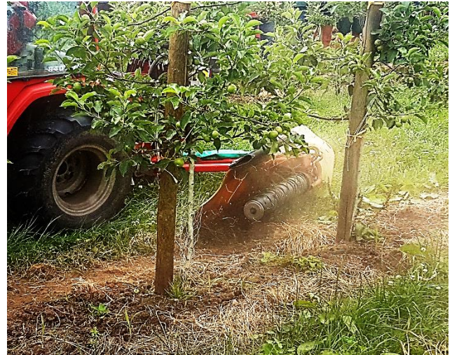
Foto 2. Draadjesmaaier van LADURNER in actie, Foto: N. Oeser, FÖKO, 2018.
