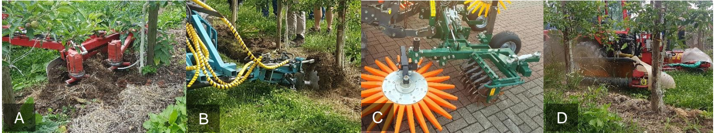
Verschillende mechanische onkruidmachines: Foto A. LADURNER Rijenrees, Foto B. SPEDO schijvenploeg, Foto C. Combinatie van Rolschoffel en vingerwieder (Adelhelm & K.U.L.T. Kress), Foto D. LADURNER Draadjesmaaier. Foto's: N, Oeser, 2018.
