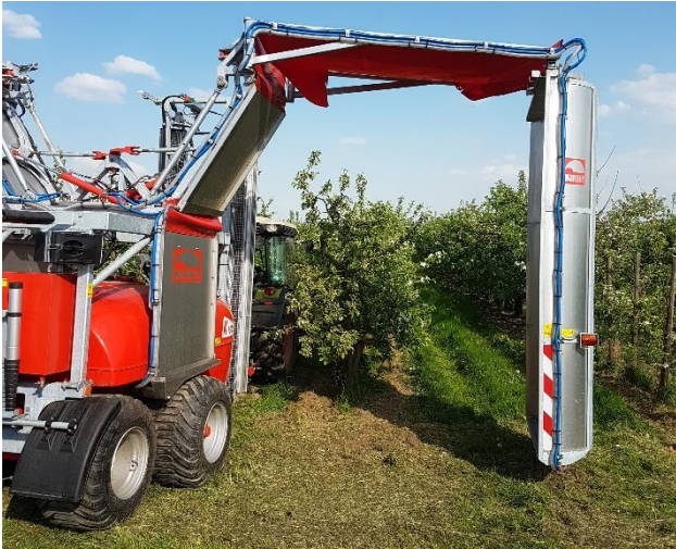
Foto 2: WANNER NTR20 Reflector-recycling spuit. Foto: N. Oeser, 2018.
