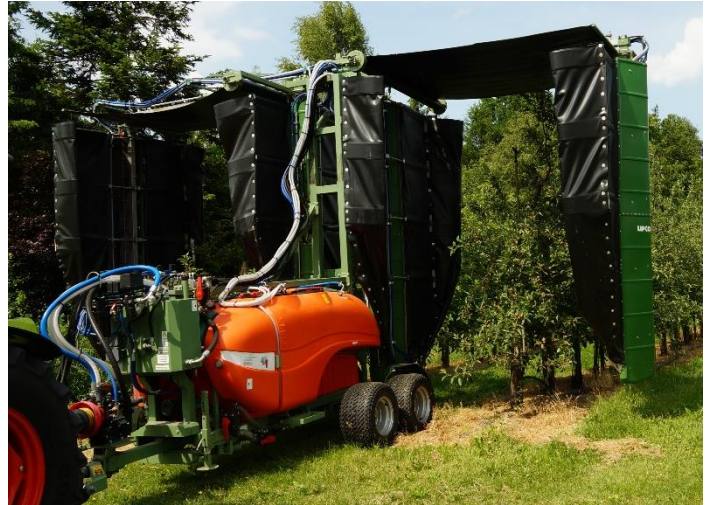
Foto 1: LIPCO OSG-NVM2 Recycling-Tunnelspuit. Foto: Ralfs, 2017.
